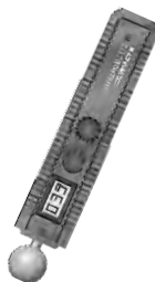
Влагомеры для анализа влажности основания карбидно-кальциевым методом (Hydromat CM-B, HB30)
